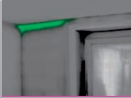
Küf oluşma risk noktalarını belirlemek için yüzey nem ölçümü
