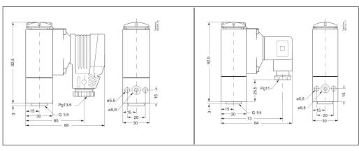
Plug Pg 13.5, DIN 43650 Plug Pg 9-11, DIN 43650
