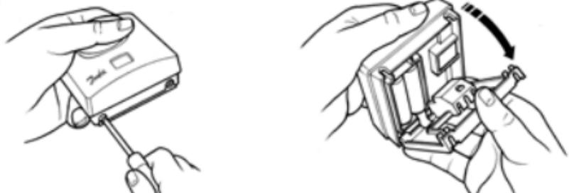
Die Befestigung des Raumthermostaten sollte in einer Höhe von 1,5 m über dem Boden, frei von Luftzug oder Wärmequellen, wie z. B. Heizkörpern, offenen Feuerstellen oder direktem Sonnenlicht, erfolgen.
