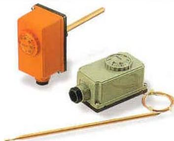
Termostato ad immersione incatolato ad espansione di liquido, unipolare, con i contatti in commutazione, completo di guaina di protezione a tenuta stagna. Il termostato normalmente applicato sulle tubazioni di mandata è particolarmente adatto alla regolazione automatica di caldaie, pompe e altre varie applicazioni. E' inoltre disponibile nella versione a capillare. Omologazioni: ENEC, DIN, ISPESL, Conformità direttiva PED.
